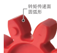
转矩传递面为圆弧形。配合倒角减少安装误差产生的反作用力。
