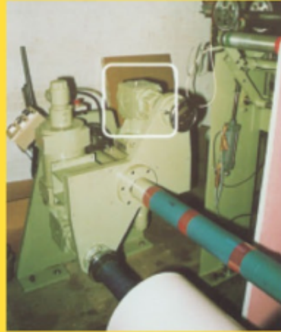
伞齿齿轮箱在印刷行业的卷取装置上的应用
